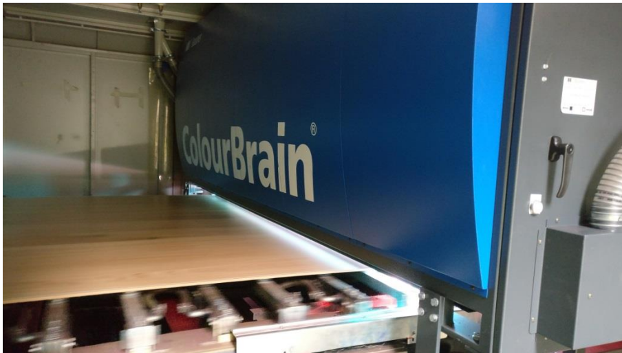
Installation in Single Pass Hyphen Linie mit Druckbreite 2.250mm
